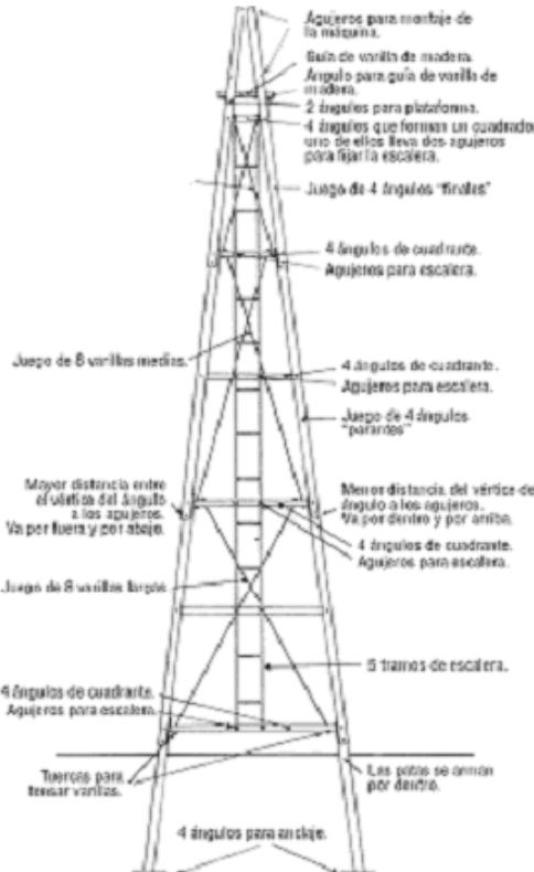
La Torre THUNDER se entrega con una palanca para cerrar el molino; cuatro tablas para armar la plataforma, dos varillas cuadradas de madera (si la torre es de 9 m) y tres varillas si es de 12 m para movimientos de cilindro; un trozo de alambre galvanizado para freno, tuercas, buferones, etc. Las torres de 12 metros se arman de la misma forma que las de 9 metros.
